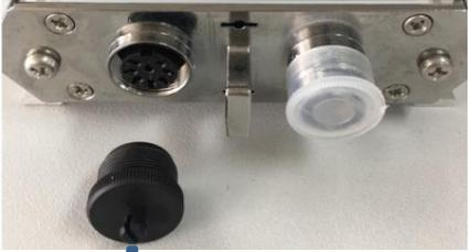
①取下天线上的AISG接头保护盖。
