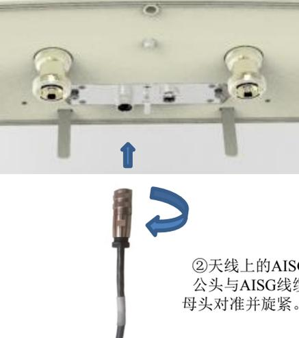
②天线上的AISG公头与AISG线缆母头对准并旋紧。
