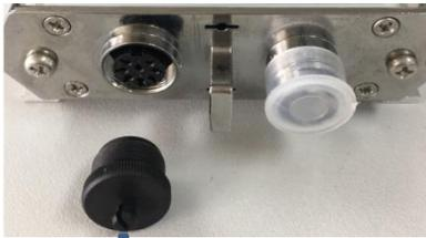
①取下天线上的AISG接头保护盖。
